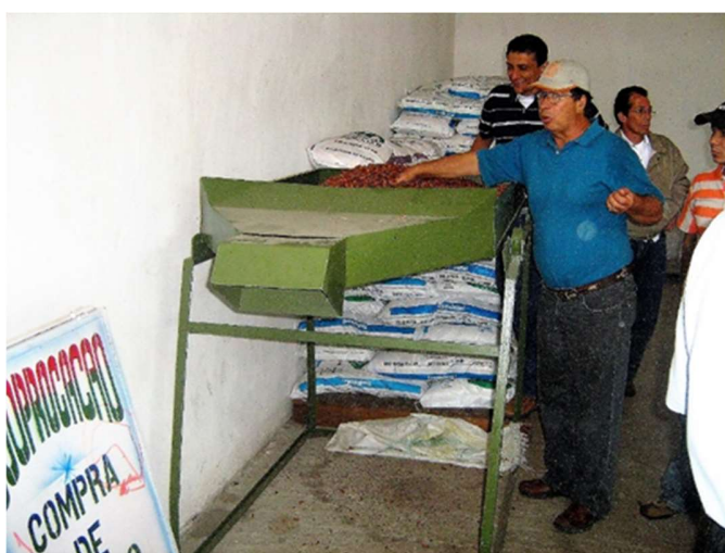
Figura 73. Equipo artesanal para limpieza y clasificación de los granos de cacao.
