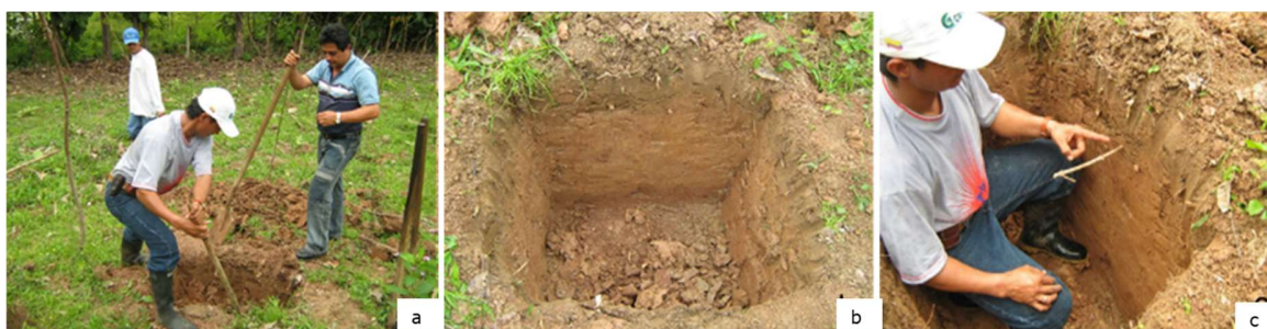
Figura 20. Identificación de las características del suelo. a. Elaboración de la calicata; b. Calicata de 1 \times 1 \times 1 m; c. Análisis de las características físicas de la calicata.
