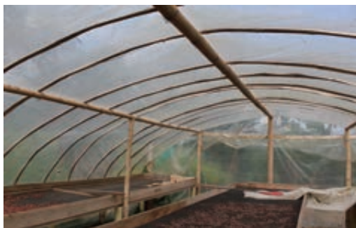
Figura 141. | Secador tipo marquesina
