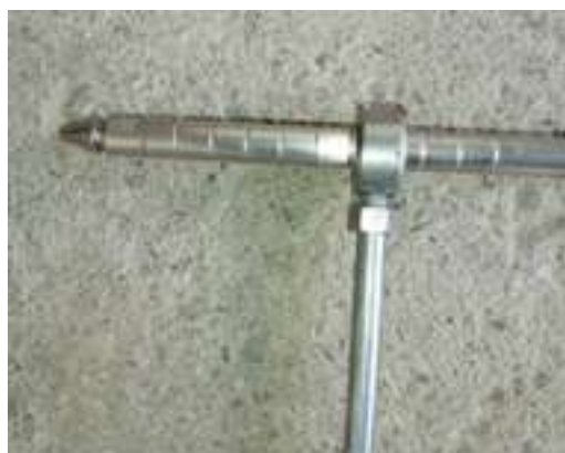
📷 Figura 50. Lanza de aplicación en drench para manejo químico de chisas en el cultivo de arracacha
