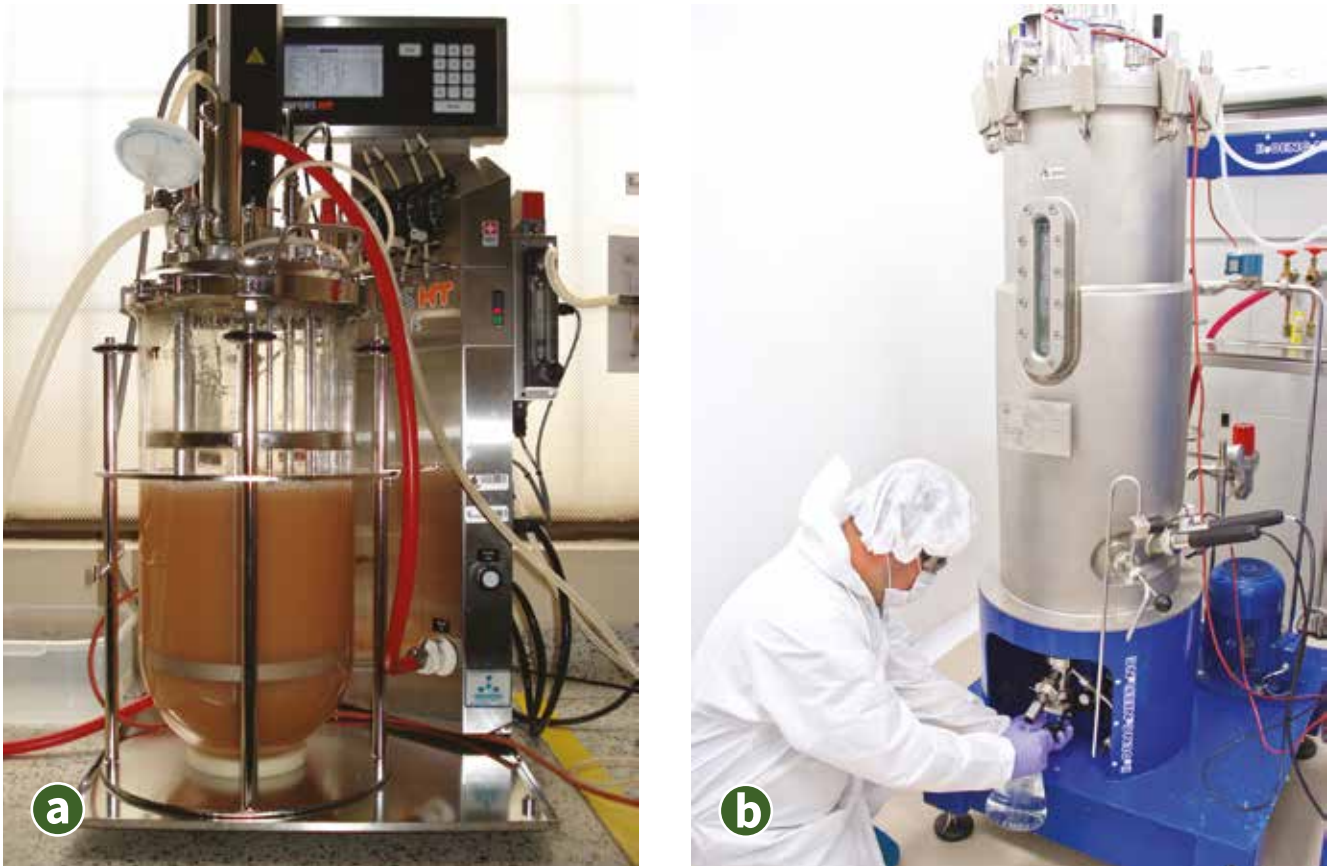
Figura 12.5. Biorreactores de tanque agitado (STR) usados para la producción de bioplaguicidas. a. Biorreactor escala laboratorio de 10 litros; b. Biorreactor escala piloto de 100 litros.
