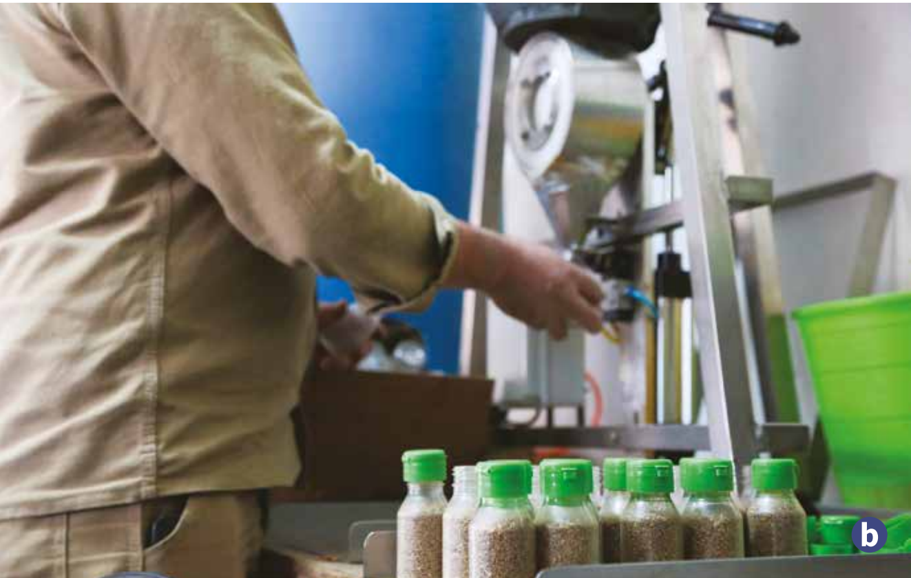
Figura 14.5. Proceso de limpieza y empaque del producto. a. Limpieza del material colectado en invernadero: en esta fase se eliminan impurezas aspiradas durante el proceso de cosecha de los ácaros depredadores; b. Proceso de empaque de P. persimilis .
