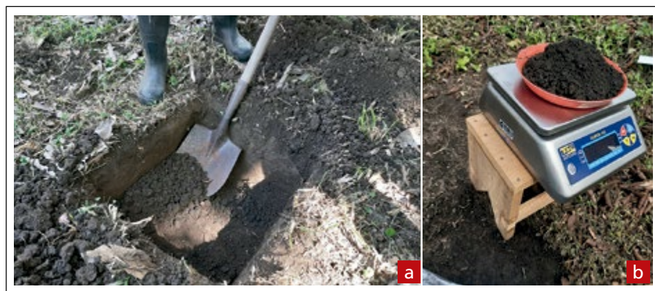
Figura 1. Toma de muestra de suelo. a. Toma de muestra de suelo a 20 cm de profundidad; b. Pesaje de 1 kg de suelo (muestra disturbada) para análisis en laboratorio.
