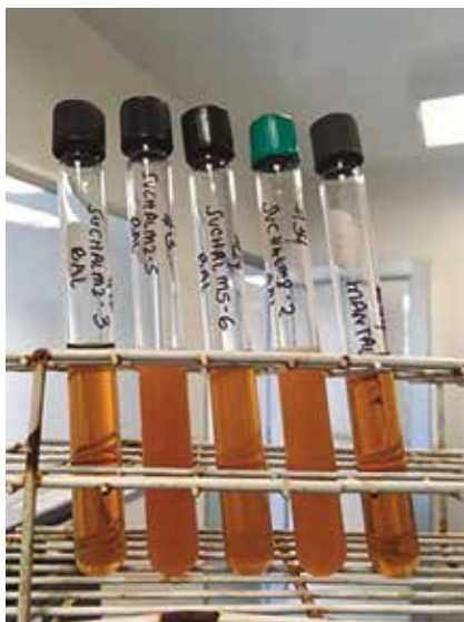
Figura 39. Tubo tipo Hungate con tapón de butilo y tapa rosca.
