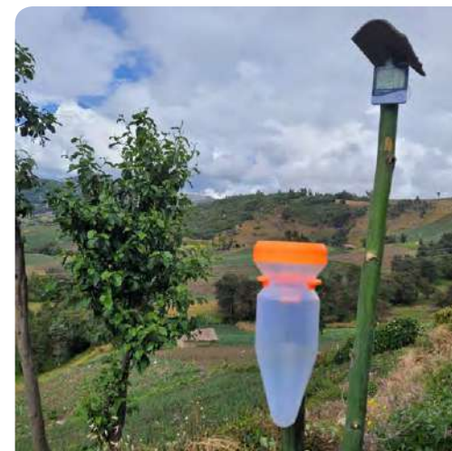
Figura 9. Estación de monitoreo agroclimático participativo con pluviómetro y medidor de temperatura y humedad. Foto: Ivonne Tristancho.
