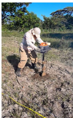
Figura 15. Ahoyador mecánico; Granada, Meta, 2017.
