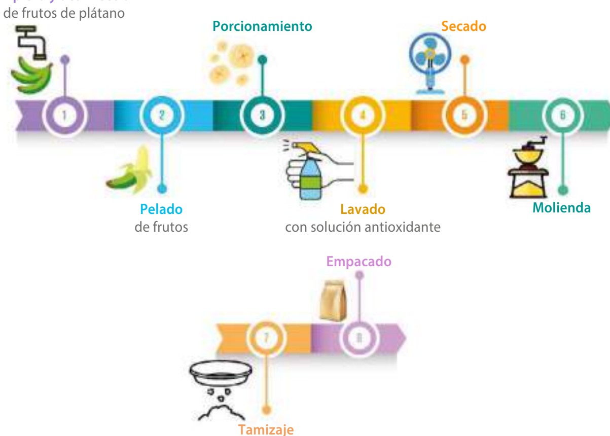
Figura 131. Diagrama del proceso para elaboración de harinas de plátano.
