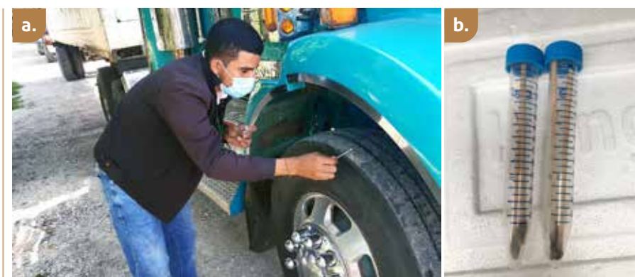
Figura 25. Pasos del protocolo de muestreo en puestos de control. a. Toma de muestra con hisopo, frotis de llanta; b. Estado final de la muestra para envío a laboratorio.
