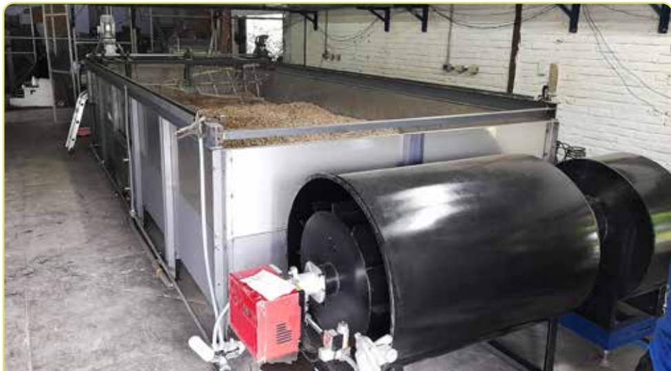
Figura 4.5. Principales equipos y componentes del sistema de secado en capa fija.
