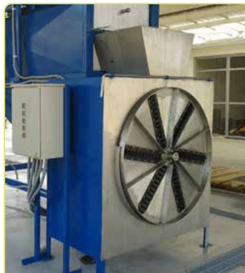
Figura 2.4. Máquina picadora de yuca con disco tipo Colombia.
