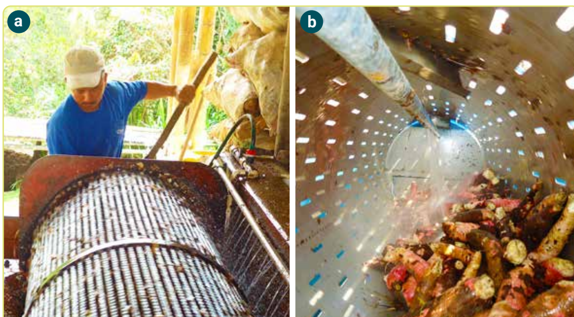
Figura 2.3. Máquina lavadora de yuca con tambor cilíndrico rotatorio. a. Desarenado de raíces; b. Cilindro rotatorio para el lavado de raíces.
