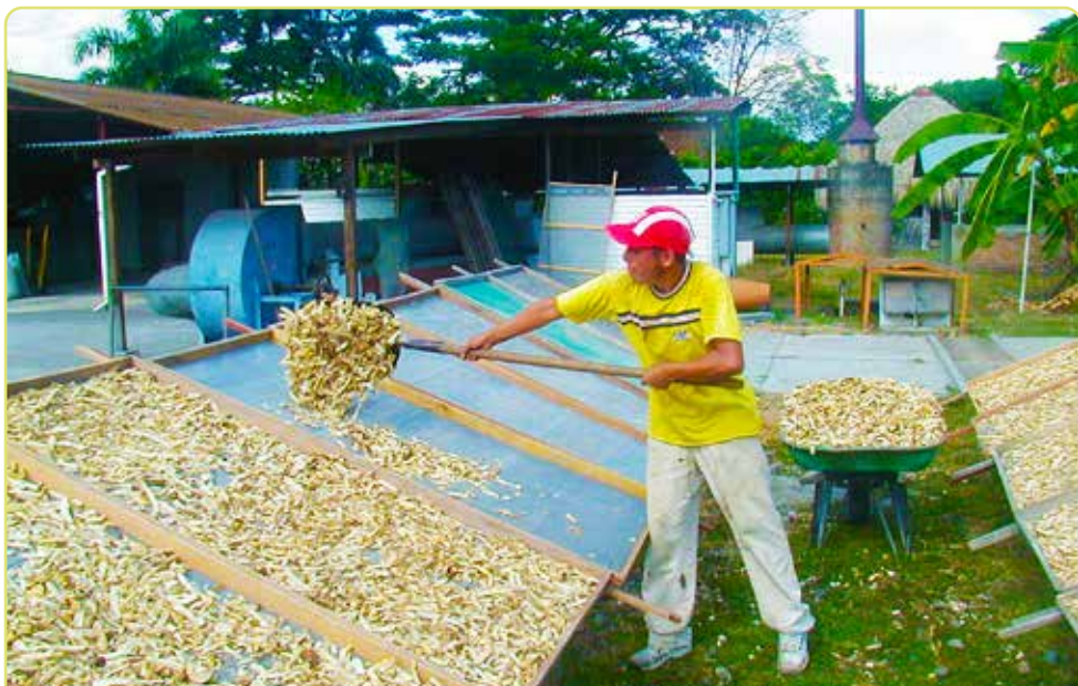
Figura 3.6. Operario llenando las bandejas de secado junto al área de la picadora.
