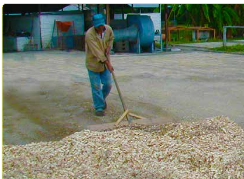
Figura 3.3. Recolección de trozos secos, amontonándolos en el patio con una pala de madera.
