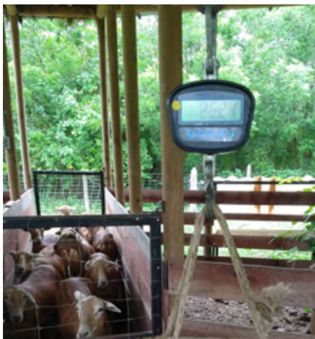
Figura 12. Báscula colgante, sostenida en una viga de madera a una altura de 1,70 m.
