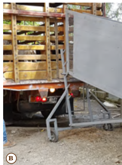
Figura 72. Mejoras en desembarcaderos o rampas de descarga utilizadas en un frigorífico del Caribe.
