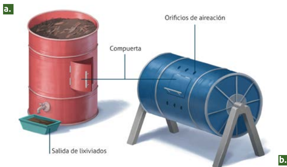
Figura 2.3. Sistemas de compostaje cerrados. a. Compostaje cerrado vertical continuo; b. Compostaje cerrado horizontal discontinuo.
