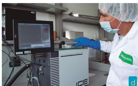
Congeladora con curva de congelación preprogramada para la criopreservación de pajillas de semen.
