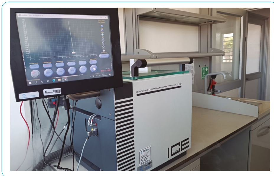
Figura 4. Equipo de congelación de semen automatizado del Laboratorio de Reproducción Animal (LRA). Foto: David Leonardo Gómez López
