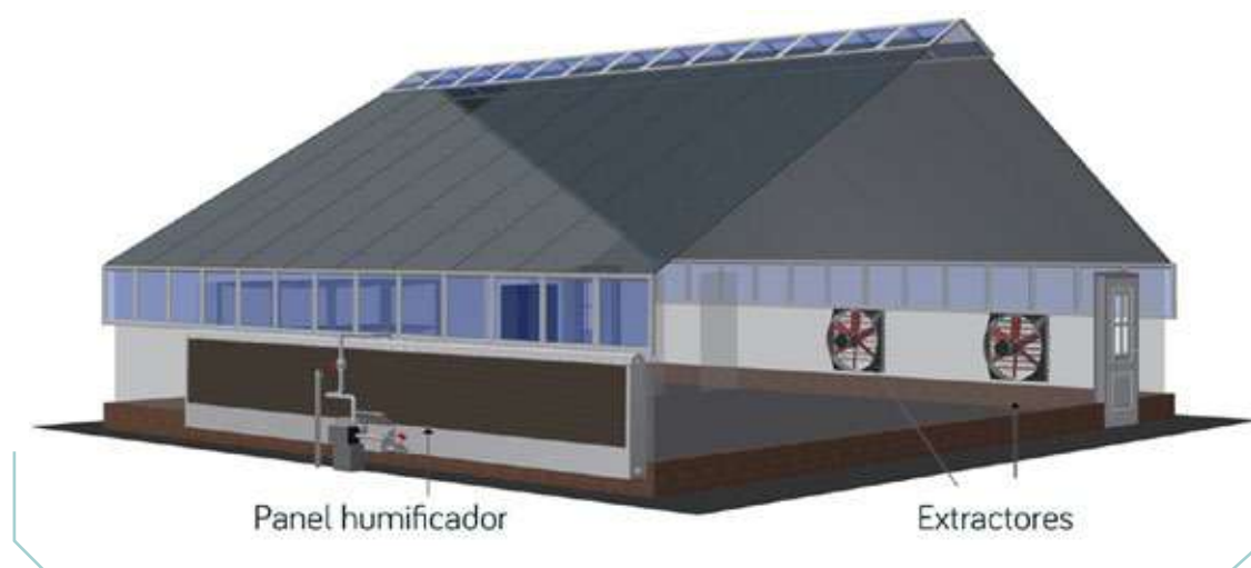
Figura 36. Enfriamiento por extracción de aire y almohadilla evaporativa.
