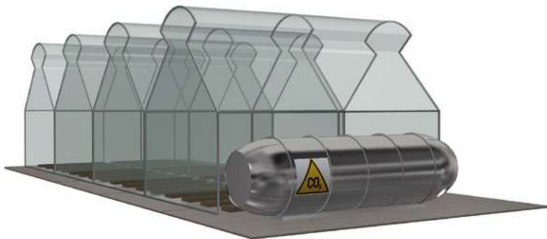
Figura 39. Sistema de inyección de \text{CO}_2 purificado.
