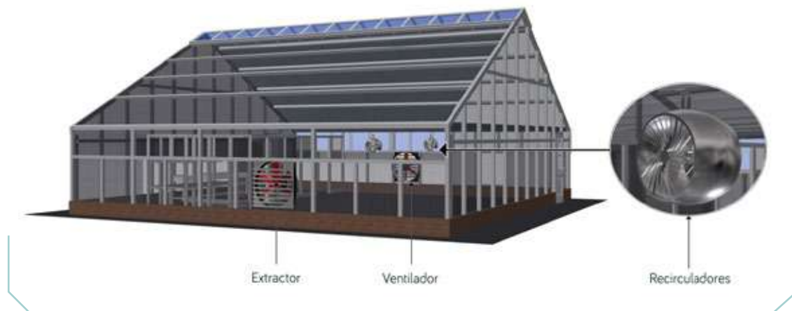
Figura 34. Método de ventilación forzada mediante extracto y soplador.
