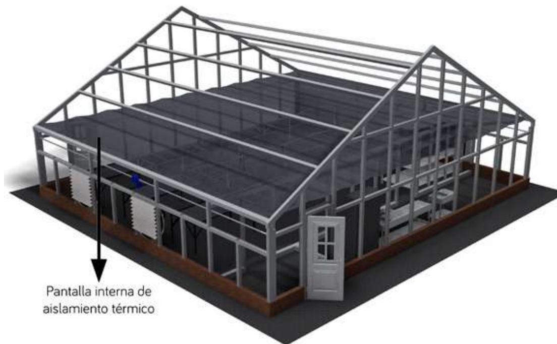
Figura 44. Pantalla interna de aislamiento térmico.
