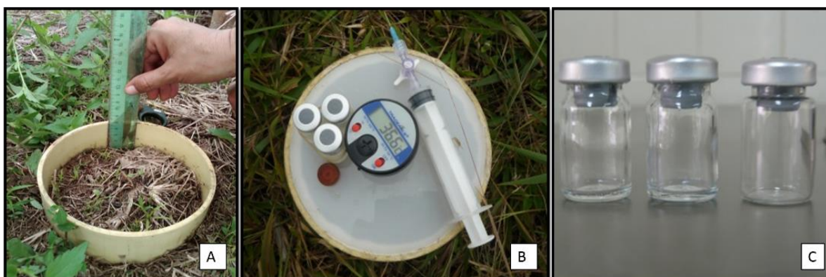
Figura 47. Técnica de la cámara cerrada: a. Instalación de la base de la cámara cerrada en los sistemas evaluados; b. Cámara cerrada al momento de la toma de muestras de gases; c. Viales al vacío
