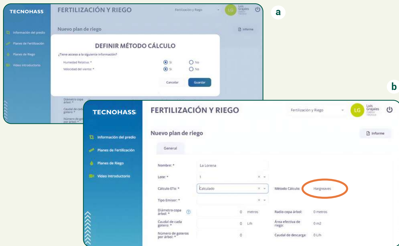
Figura 55. Definición de las opciones de humedad relativa y velocidad del viento (a) que permiten elegir el método Hargreaves (Hargreaves & Samani, 1985) para calcular la ETo (b).
