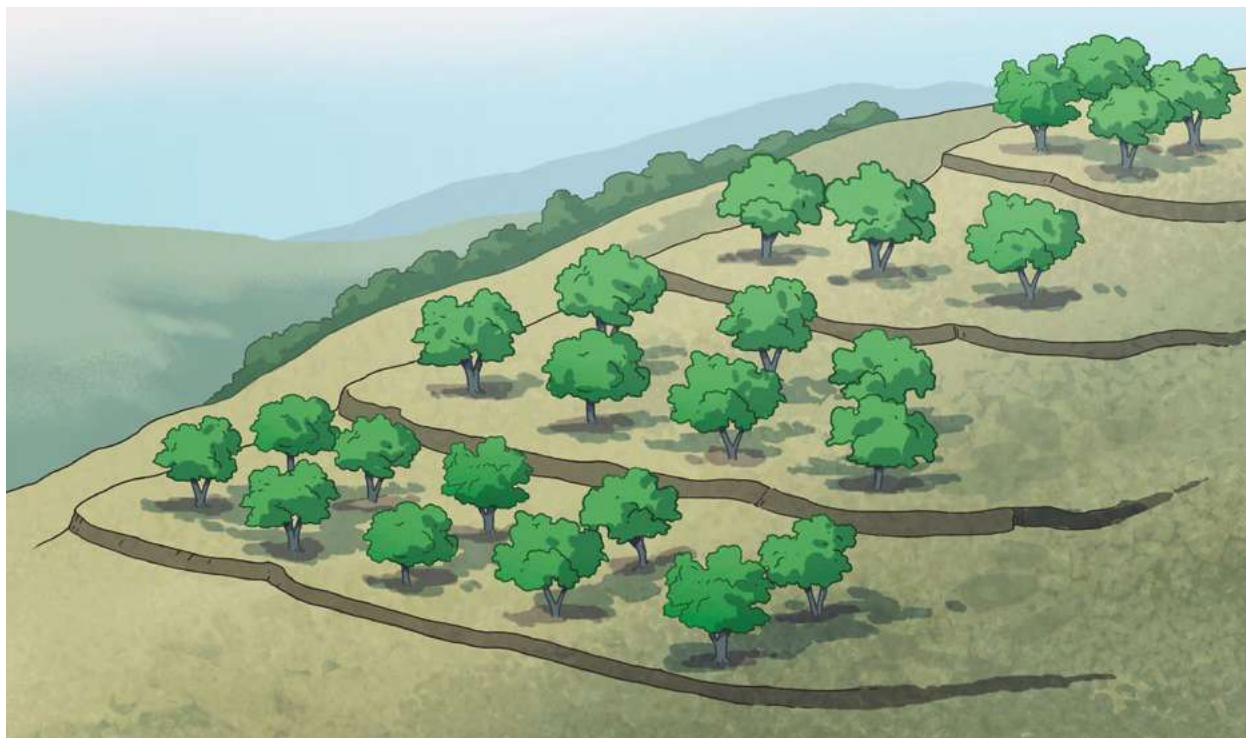
Figura 71. Tipos de terrazas utilizadas para disminuir el riesgo de erosión en los suelos de ladera.
