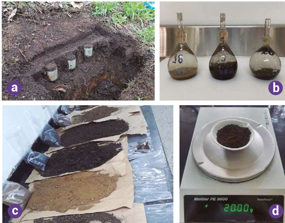
Figura 27. Muestreo para análisis de propiedades físicas y procesamiento en laboratorio. a. Uso de cilindros para estimación de densidad aparente, retención de humedad y conductividad hidráulica; b. Método de picnómetro para determinar la densidad real; c y d. Muestras disturbadas para análisis de textura por Bouyoucos.
