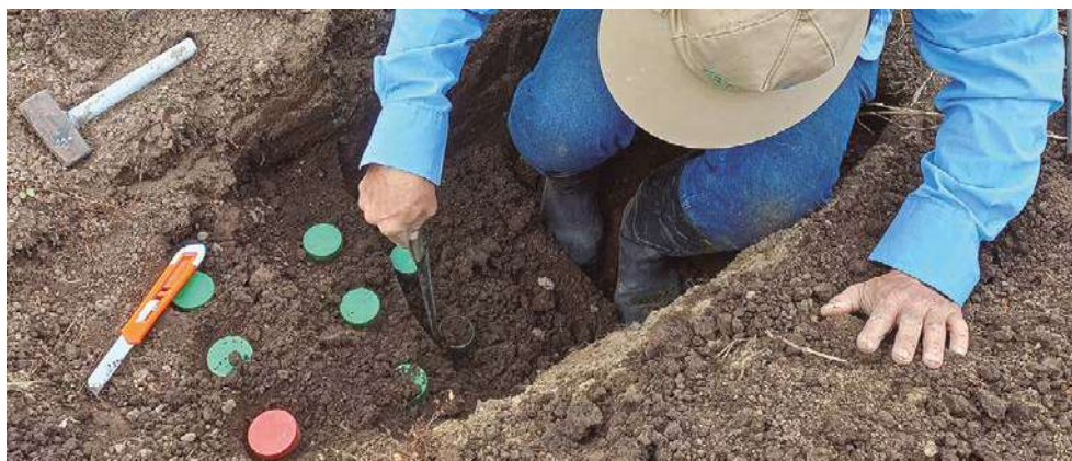
Figura 29. Procedimiento para tomar muestras sin disturbar. a. Elaboración de cajuela escalonada según profundidad para la toma de muestras; b. Uso de dispositivo para introducir cilindro en el suelo; c. Toma de muestras en cada profundidad; d. Limpieza de suelo adicional adherido al cilindro; e. Rotulación y empaque de muestras inalteradas en cilindro.
