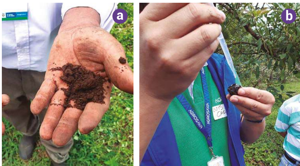
Figura 26. Determinación de materia orgánica del suelo mediante método de peróxido de hidrógeno. a. Toma de la muestra; b. Adición de agua oxigenada o peróxido de hidrógeno.
