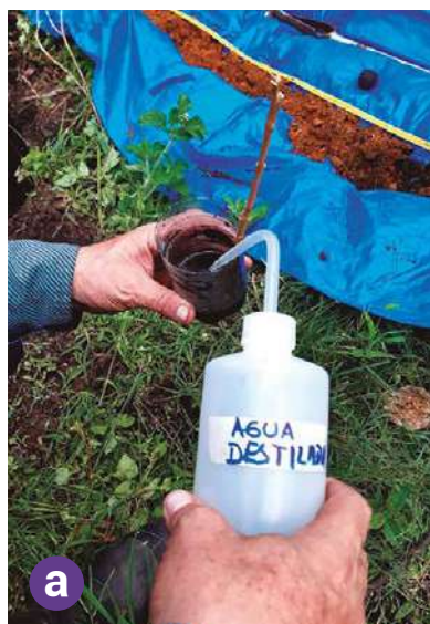
Figura 25. Pasos para determinar el pH en el suelo. a. Mezcla de agua destilada con la muestra pulverizada; b. Inmersión de la cinta indicadora en la mezcla; c. Determinación del pH del suelo mediante método cinta indicadora (0 – 14).
