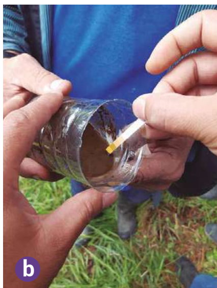
Figura 25. Pasos para determinar el pH en el suelo. a. Mezcla de agua destilada con la muestra pulverizada; b. Inmersión de la cinta indicadora en la mezcla; c. Determinación del pH del suelo mediante método cinta indicadora (0 – 14).
