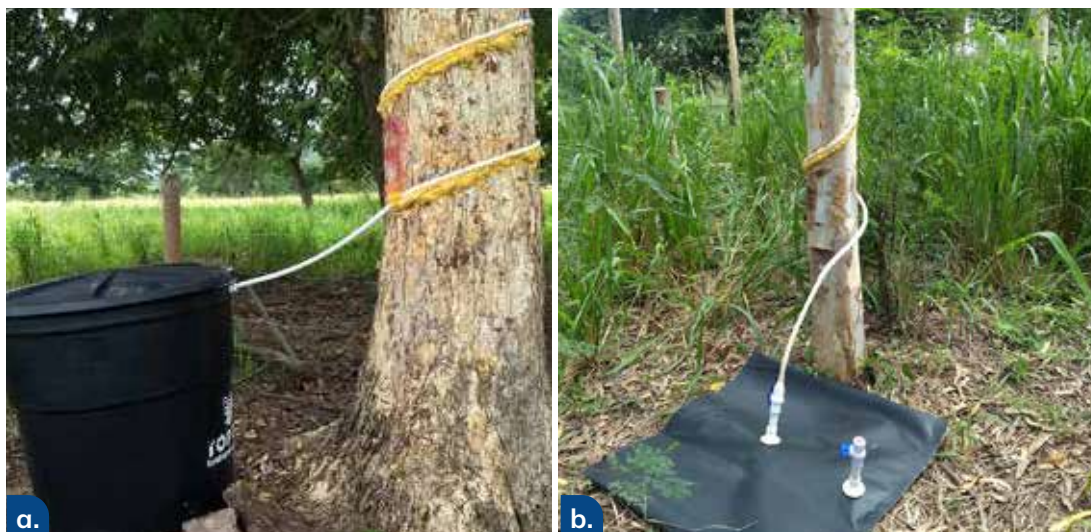
Figura 4.7. Dispositivos colectores de agua escurrida por el tronco de los árboles. a. Colector tipo tanque; b. Colector tipo bolsa de geomembrana.
