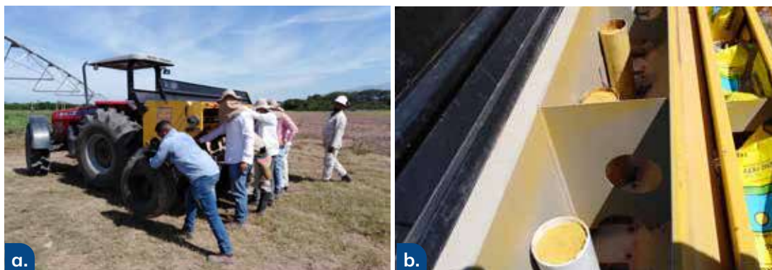
Figura 3.3. Calibración de la sembradora en campo. a. Verificación de la calibración; b. Vista de las minitolvas con las semillas.
