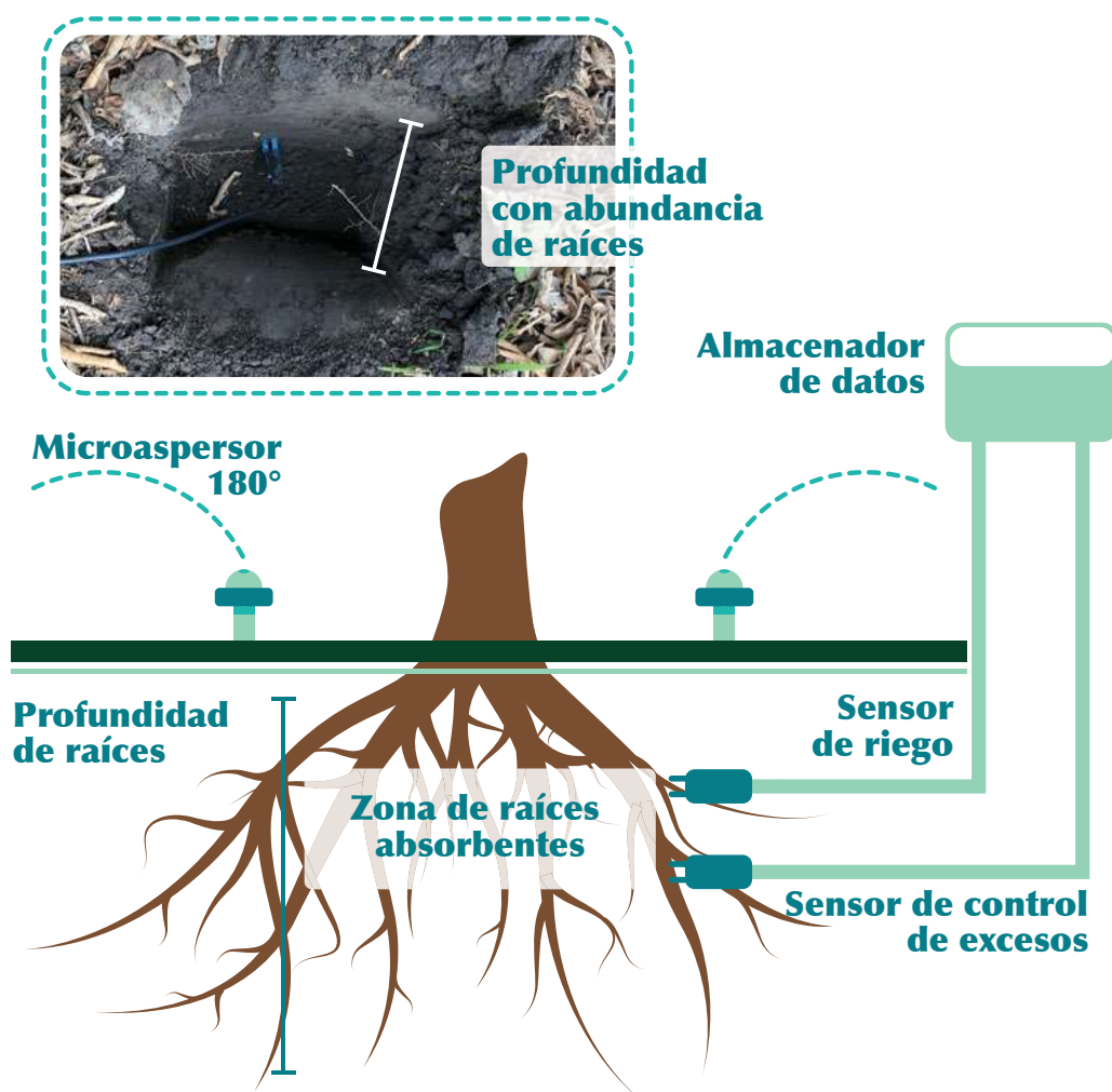
Figura 11. Esquema de ubicación de un sensor de capacitancia.
