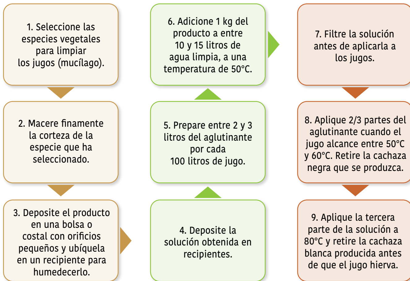
Figura 21. Proceso para fabricar y utilizar mucílago para la elaboración de panela.
