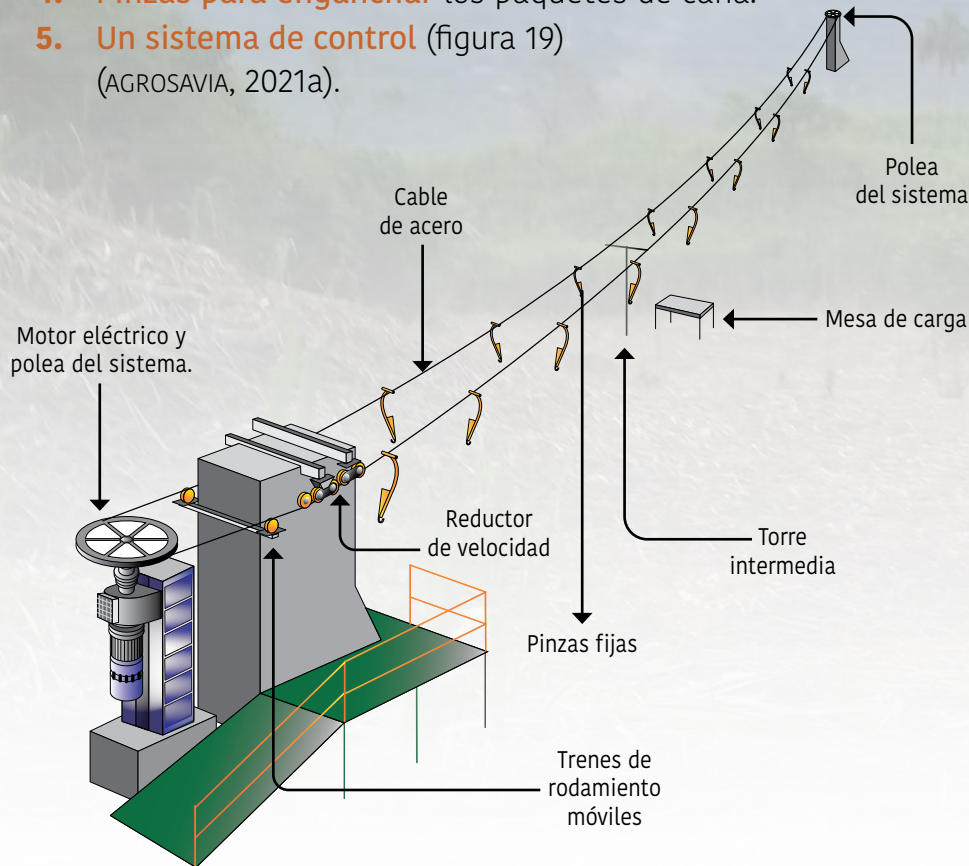
Figura 19. Sistema de transporte de caña por cable autopropulsado desarrollado por AGROSAVIA. a. Desplazamiento de los paquetes de caña por el cable autopropulsado; b. Motor eléctrico de 15 HP y polea del sistema; c. Punto de cargue de paquetes de caña (aproximadamente 50 kg).
