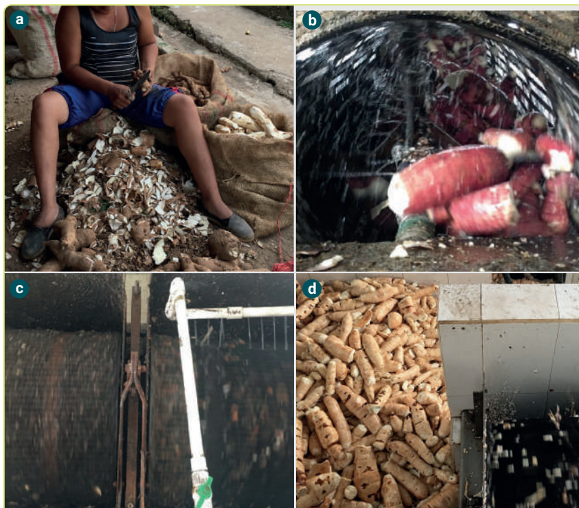
Figura 12.5. Pelado y lavado de yuca. a. Pelado manual; b. Fricción de las raíces dentro del cilindro de lavado; c. Etapas de desarenado y lavado de yuca; d. Raíces lavadas y peladas.
