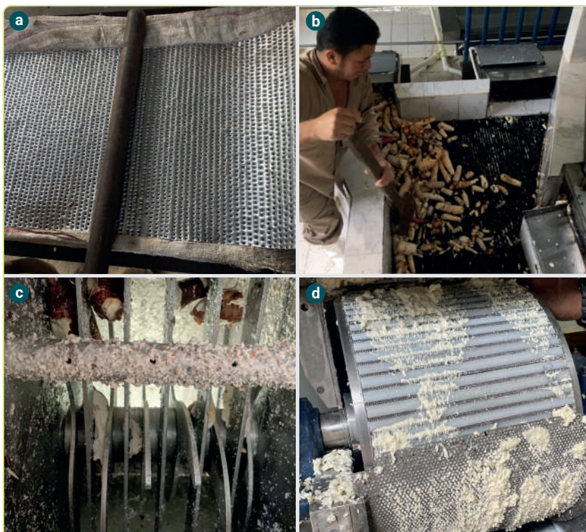
Figura 12.6. Rallado de yuca. a. Lámina de metal perforada; b. Alimentación de raíces al rallo; c. Prototipo de trazadora de yuca; d. Prototipo de rallo de seguetas.
