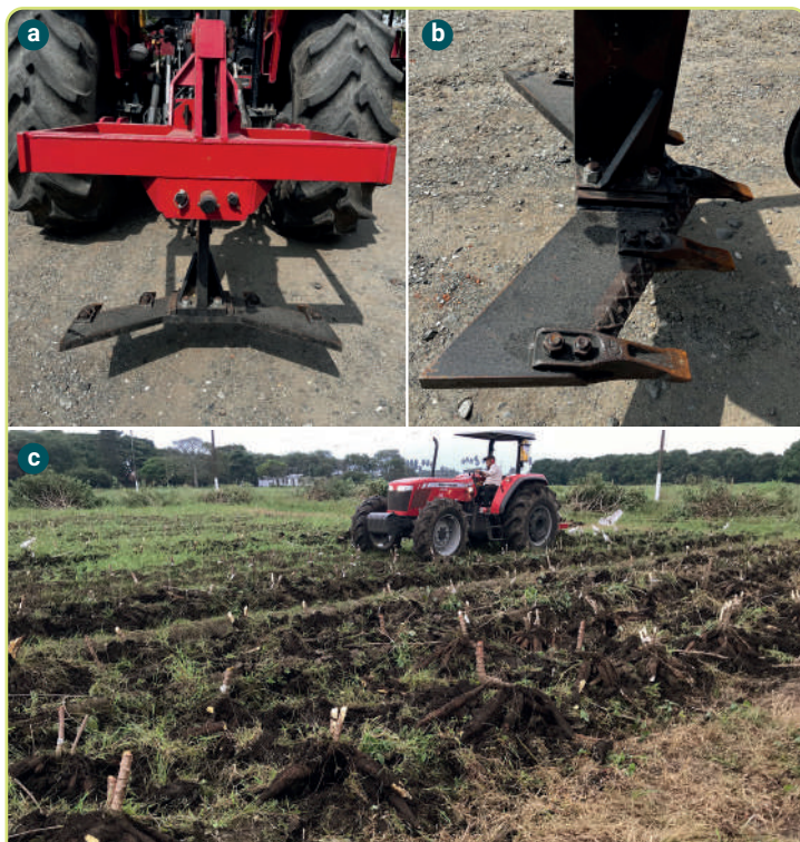
Figura 6.30. Cosecha mecanizada de yuca. a. Cosechadora enganchada al tractor; b. Implemento para la cosecha; c. Cosecha mecanizada en una zona plana del Valle del Cauca.
