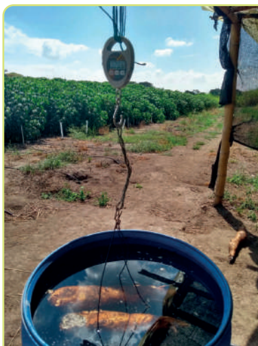
Figura 6.32. Peso de raíces de yuca en agua para determinar la gravedad específica.
