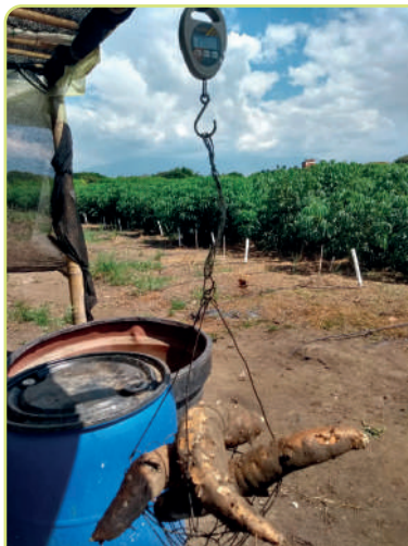
Figura 6.31. Peso de raíces de yuca en aire para determinar la gravedad específica.
