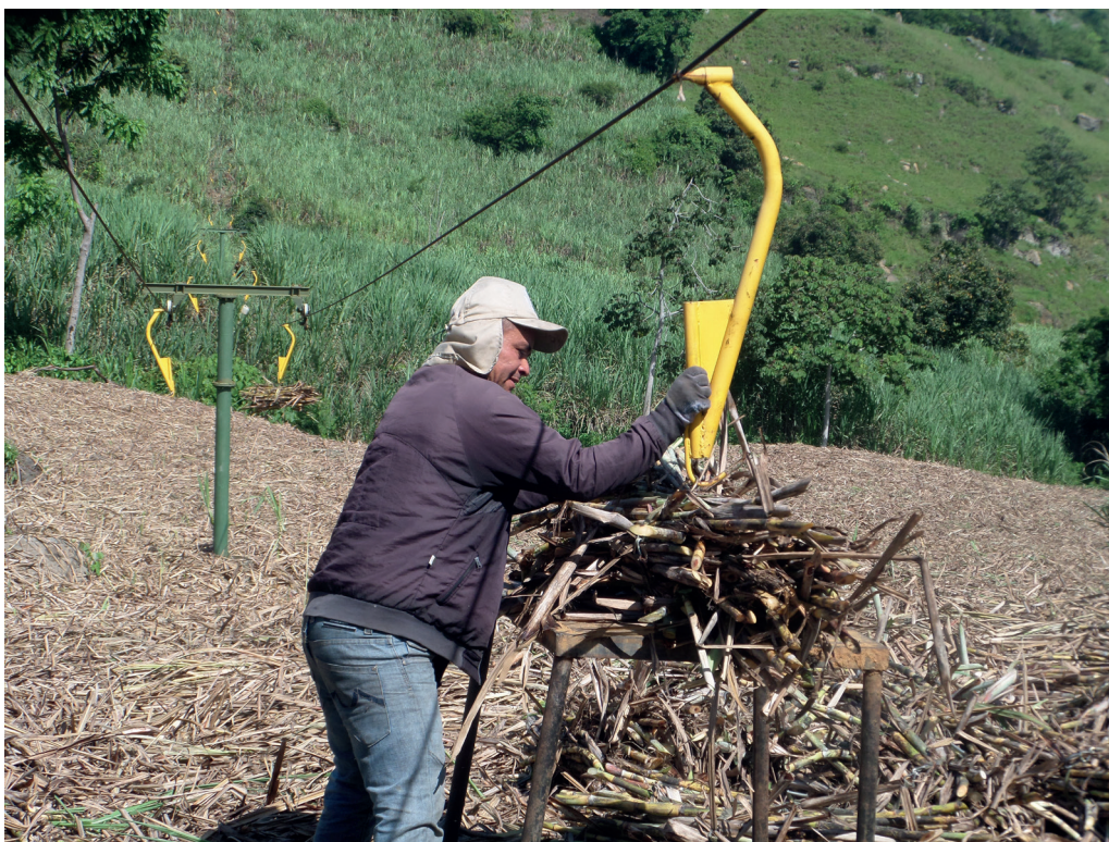
Figura 6.4. Torres intermedias de soporte del cable (color verde), pinzas y gancho de carga (color amarillo); proceso de ubicación de un paquete de caña en el gancho de la pinza.
