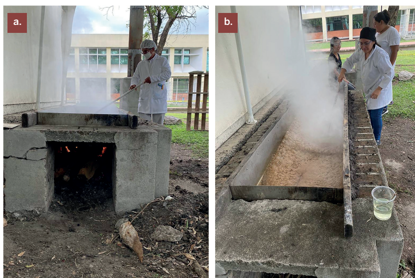
Figura 19.2. Puesta en marcha del horno para producir piloncillo. a. Vista lateral del horno (entrada de alimentación del fuego); b. Paila con jugo de caña de azúcar instalada en el horno para la producción de piloncillo.
