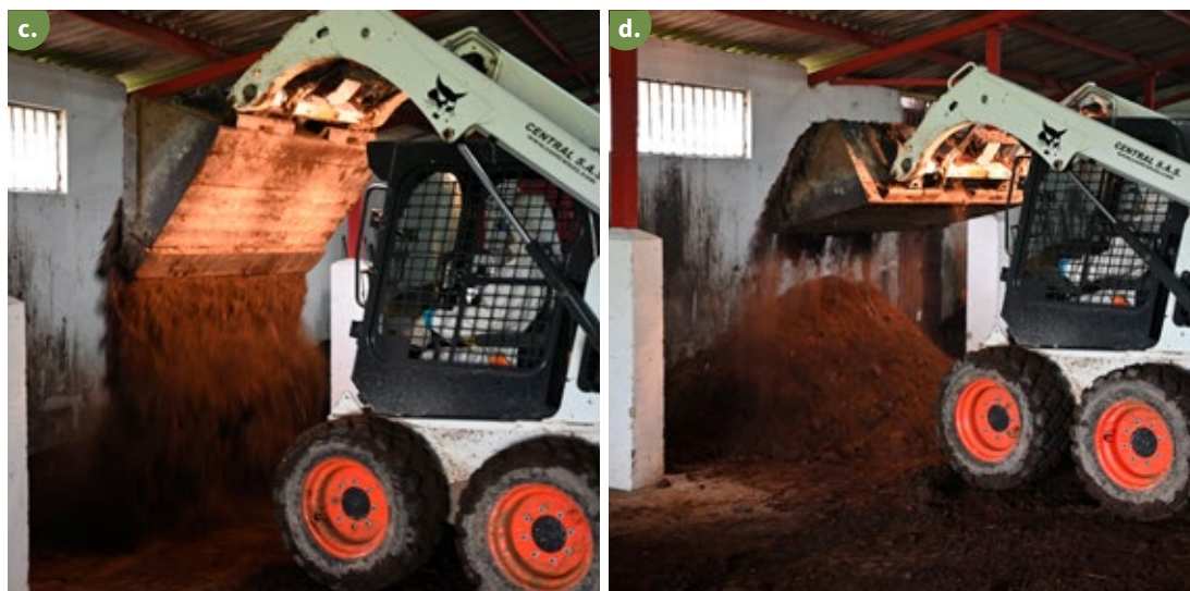
Figura 20. Volteo de la pila de compostaje con Bobcat para airear los materiales, redistribuir la humedad y mejorar la circulación del aire. a y b. Regado de la pila partiendo del centro y dejando en los bordes el material que estaba expuesto. c y d. Montaje de la pila tomando primero el material de los bordes para ponerlo en el centro de la nueva pila. De esta manera se “da vuelta” a la pila.
