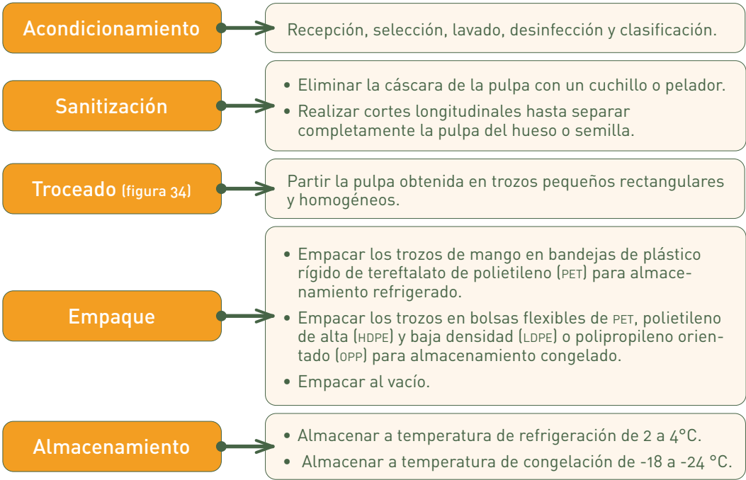
Figura 32. Diagrama de flujo para producción de mango en trozos.
