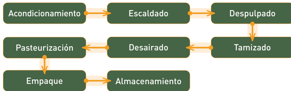
Figura 35. Diagrama de flujo para producción de pulpa de mango.
