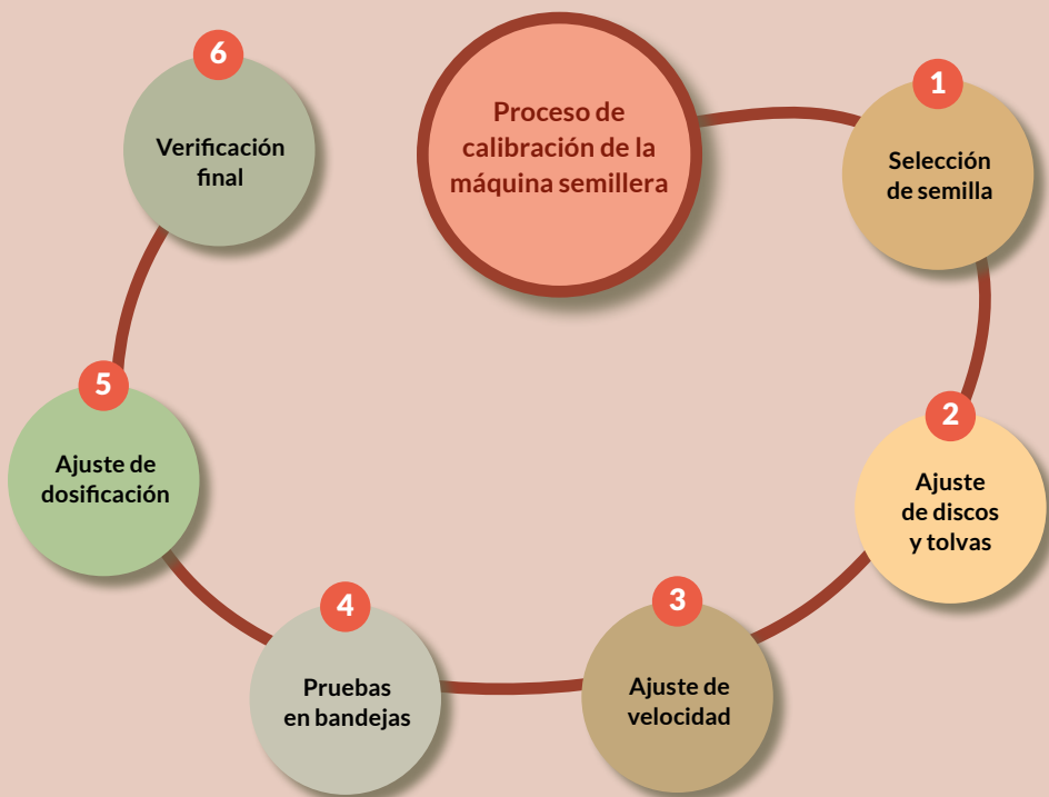
Figura 15. Proceso de calibración máquina sembradora.
