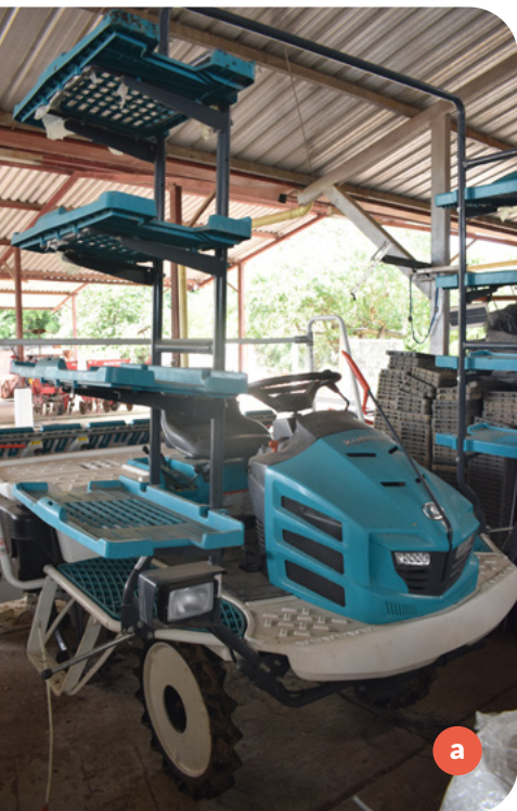
Figura 14. Máquinas trasplantadoras. a. Trasplantadora Kubota SPV-8C; b. Línea sembradora Kubota SR-K800CN 2BZP-800.
