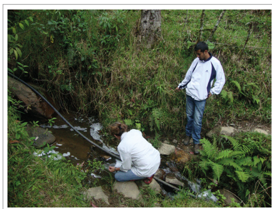
Figura 6.17. Toma de muestras de agua para análisis de calidad.
