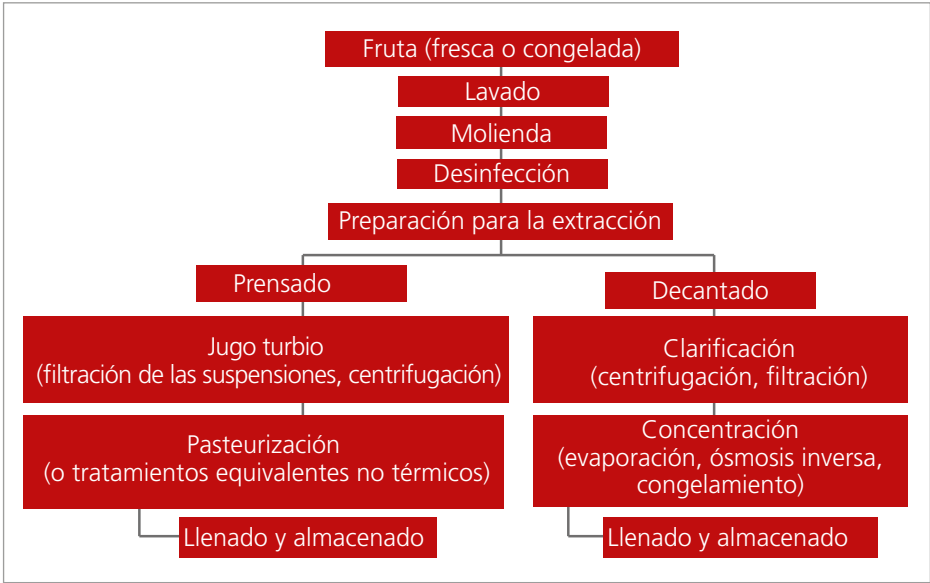
Figura 8.5. Esquema general para la elaboración de jugo de frutas.
