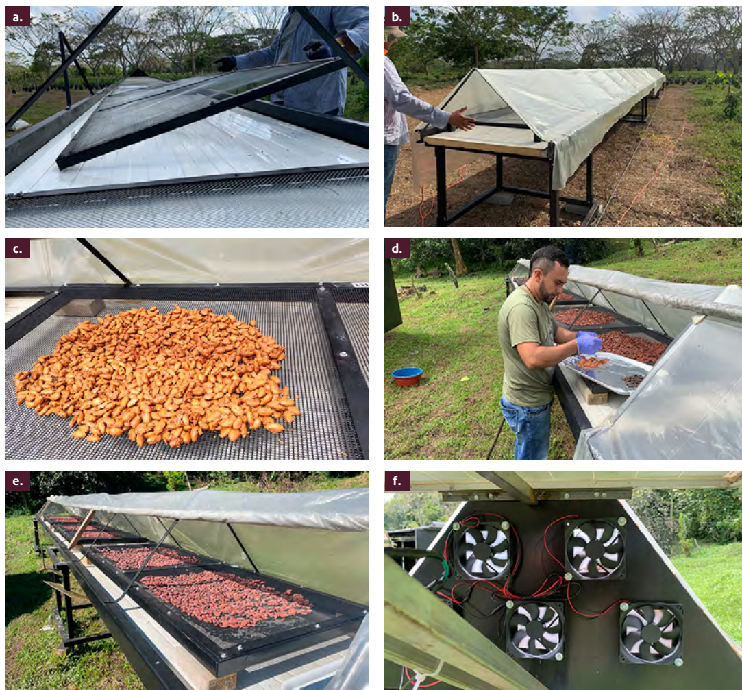
Figura 17. Módulo de secado solar. a. y b. Instalación del módulo; c. Inicio del proceso de secado; d. y e. Final del proceso de secado; f. Sistema de ventilación.
