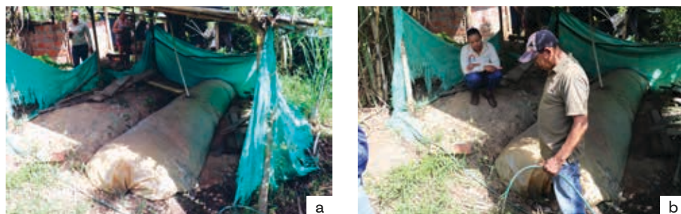
Figura 40. La producción de biogás es una práctica cultural dentro del resguardo Cañamomo Lomapieta que busca aprovechar los excrementos de corrales y galpones. a. Biodigestor de pequeña escala; b. Comunero de Santa Ana, Supía, extrayendo bioles del biodigestor, como abono orgánico para el cultivo de caña y cítricos de su chagra.
