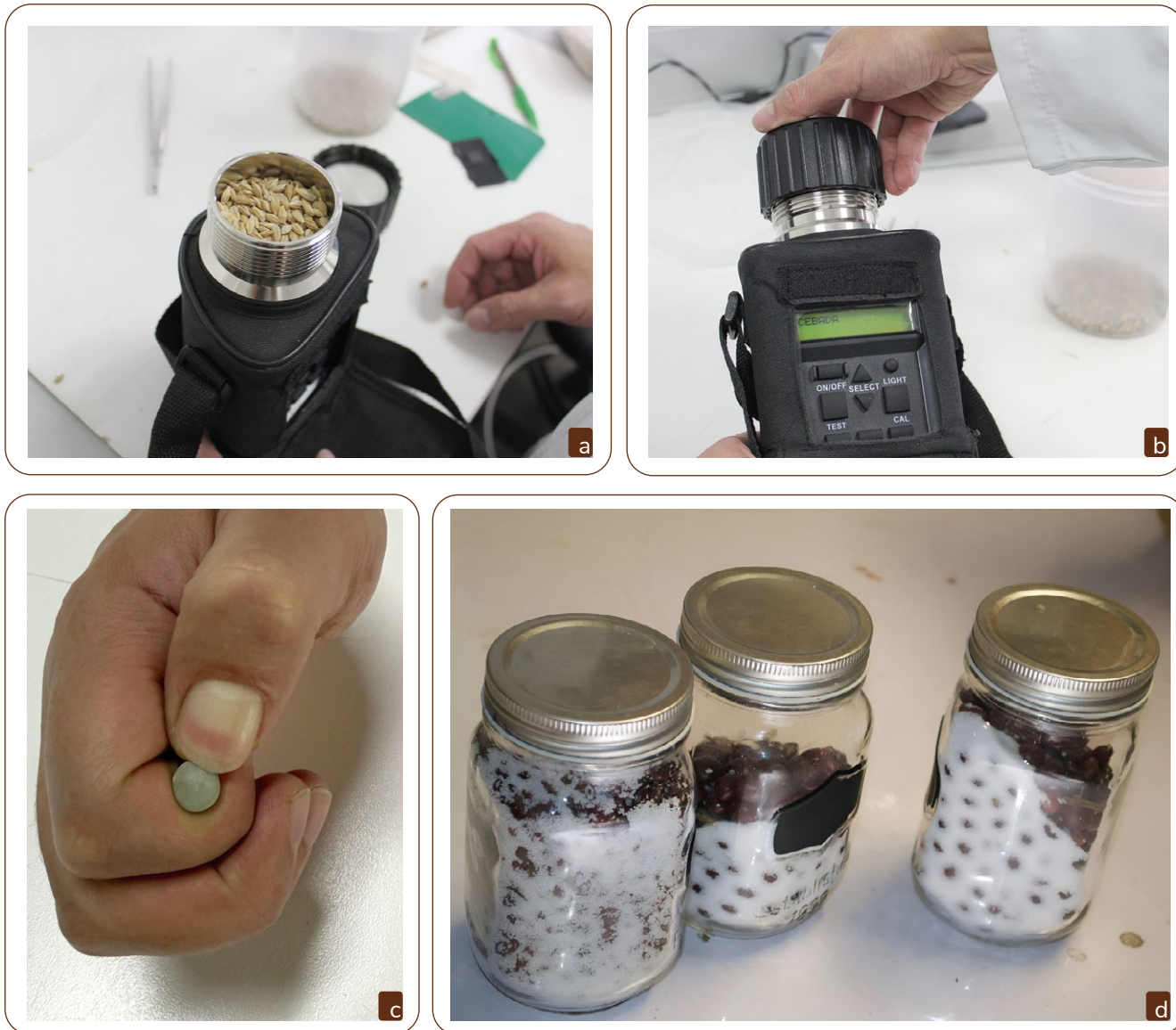
Figura 5. Métodos para medir el contenido de humedad en semillas. a. y b. Medidor de humedad de semillas digital; c. Método de la uña; d. Método de la sal.
