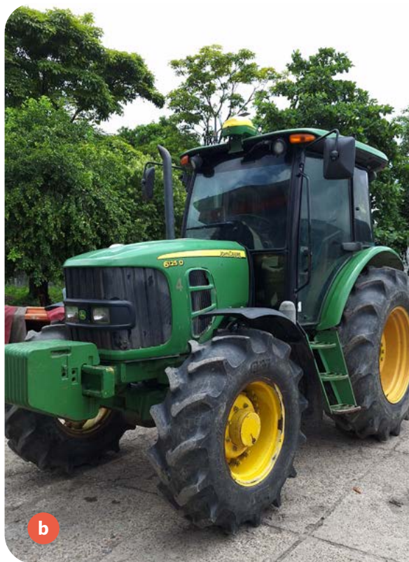
Figura 13. Dispositivos que operan con correcciones satelitales en tiempo real. a. Equipo instalado en tractor con receptor; b. Sistema RTK que opera en diferentes frecuencias con corrección ionosférica en tiempo real y precisión submétrica ( < 2 cm).
