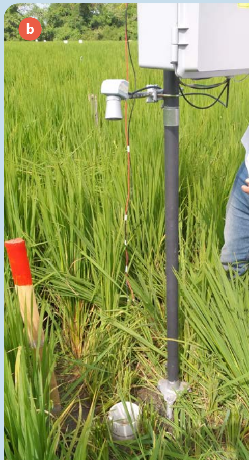
Figura 20. Monitoreo del nivel del agua. a. Tubo perforado con medición manual mediante regla graduada; b. Tubo con tensiómetro al lado para calibración; c. Tubo equipado con sensor ultrasónico.
