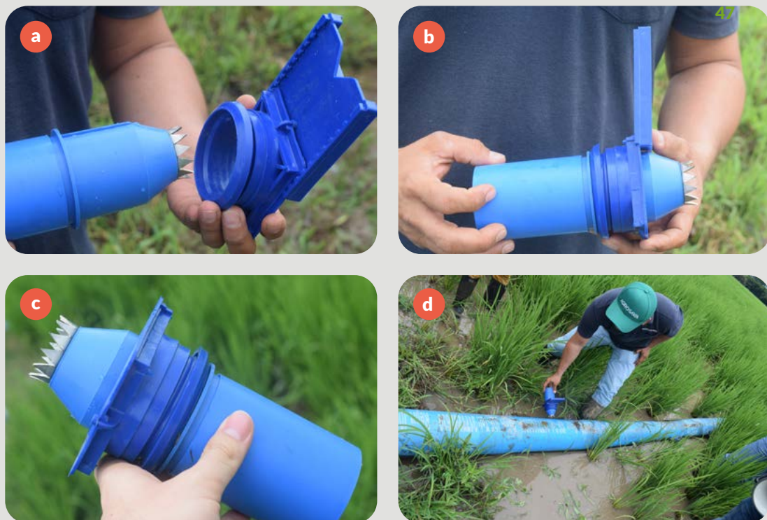
Figura 25. Proceso de armado e instalación de compuerta regulable con ayuda de insertor en manguera de riego MIRI. a. Ensamble inicial de la compuerta regulable con el insertor para perforación en la manguera; b. Alineación y cierre del sistema de acople entre compuerta e insertor; c. Compuerta regulable lista para instalación en campo; d. Instalación de la compuerta sobre la manguera de riego.
