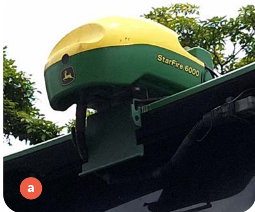
Figura 13. Dispositivos que operan con correcciones satelitales en tiempo real. a. Equipo instalado en tractor con receptor; b. Sistema RTK que opera en diferentes frecuencias con corrección ionosférica en tiempo real y precisión submétrica ( < 2 cm).
