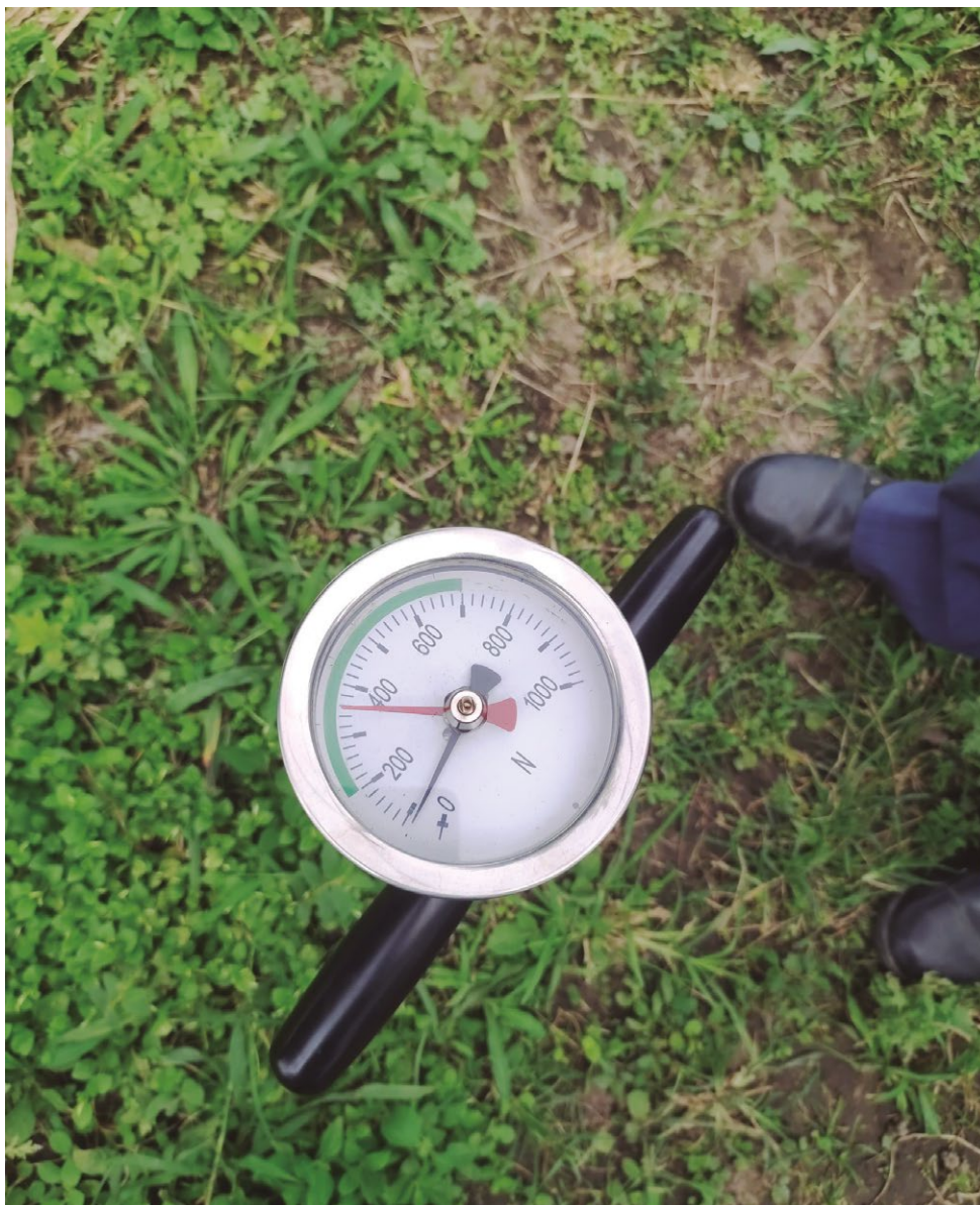
Figura 6. Medición de resistencia del suelo con penetrómetro. Foto: Mauricio Gamboa Alape
