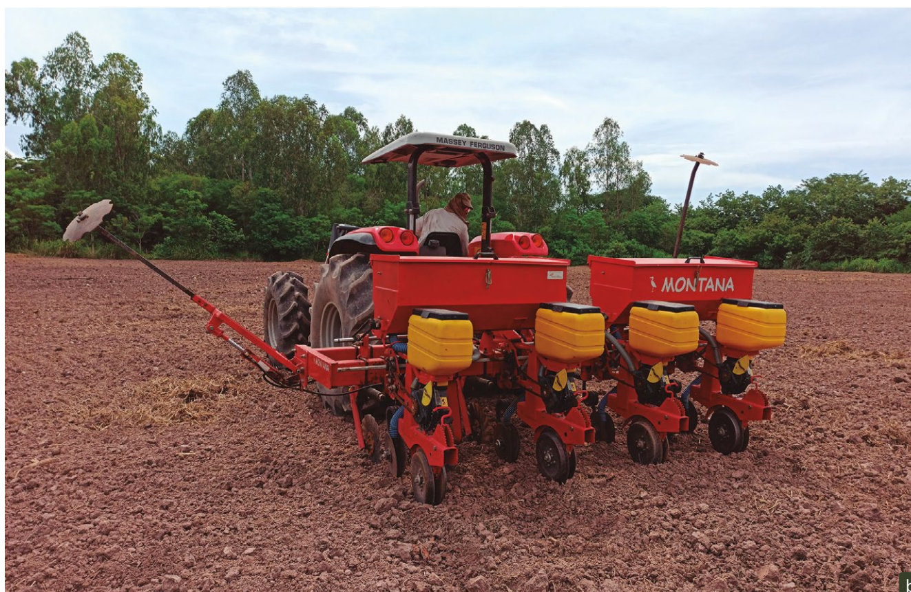
Figura 10. Preparación de sembradora para la siembra. a. Llenado de la tolva con semilla de sorgo tratada; b. Sembradora.
