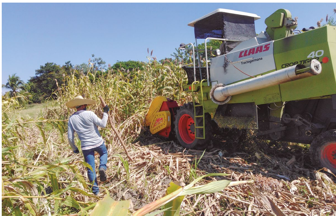
Figura 22. Cosecha mecanizada de sorgo dulce forrajero: cosechadora con cabezote. Foto: Sair Jaramillo Bonilla
