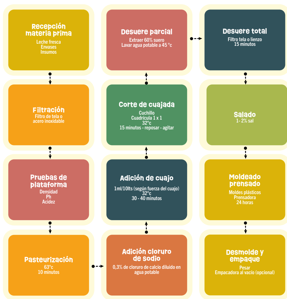
Figura 16. Diagrama de flujo del proceso de producción de queso fresco Fuente: Elaboración propia.
