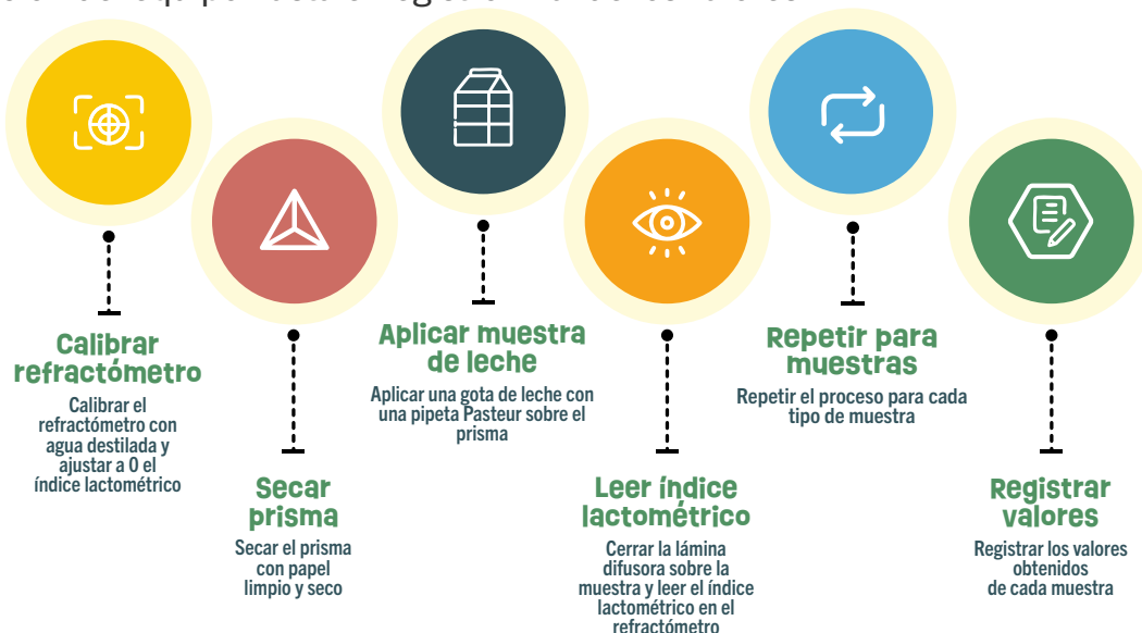
Figura 8. Descripción de proceso de medición lactométrica
