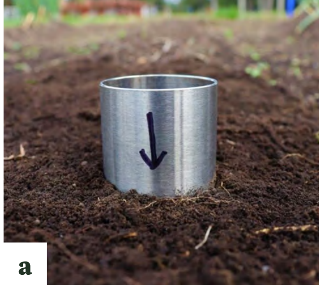
Figura 4.4. Toma de muestras para curva de retención de humedad. a. Cilindro para toma de muestra; b. Muestra tomada para la curva.
