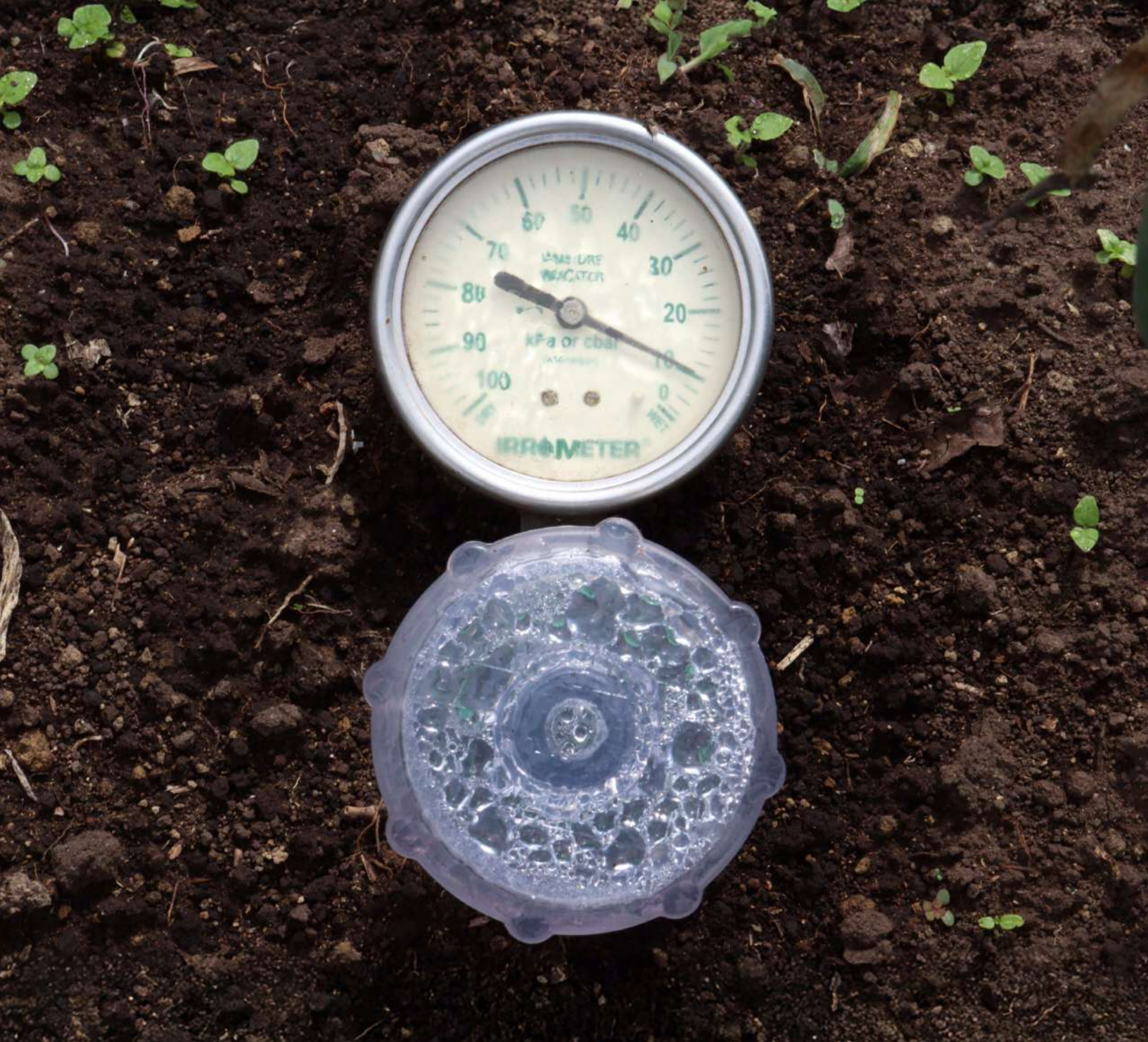
Figura 4.6. Tensiómetro instalado en el lote.
