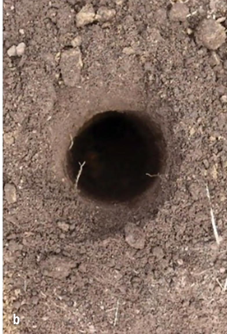
Figura 8.7. Observación del nivel freático del suelo con la metodología del barreno holandés. a. Barreno holandés para muestreo en suelo; b. Pozo de observación abierto.
