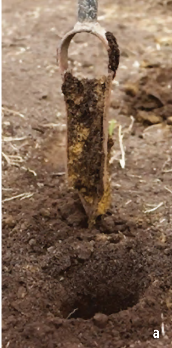
Figura 8.7. Observación del nivel freático del suelo con la metodología del barreno holandés. a. Barreno holandés para muestreo en suelo; b. Pozo de observación abierto.
