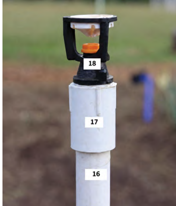
Figura 8.13. Microaspersor para zanahoria.
