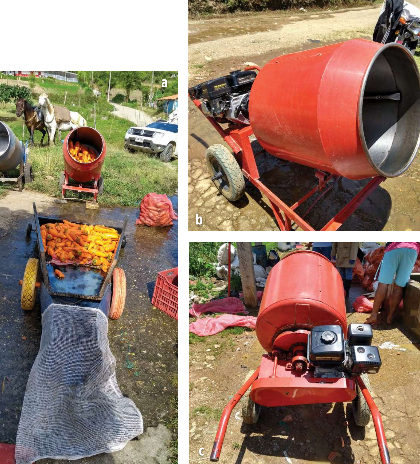
Figura 12.11. Lavado semitecnificado en finca de productor. a. Empaque de la zanahoria después del lavado; b. Máquina adaptada por los productores para el lavado (lado frontal); c. Lado posterior de la máquina.
