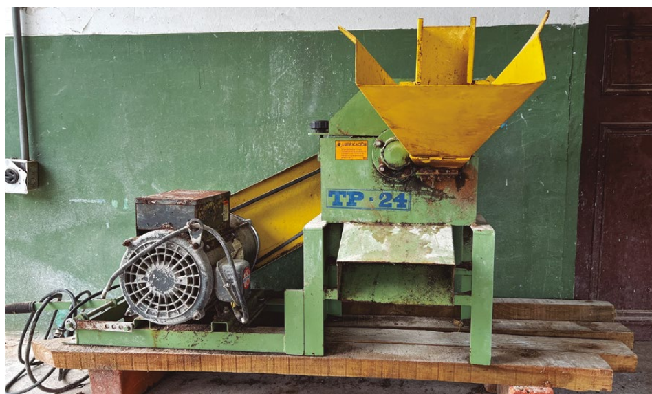
Figura 21. Molino de martillos con tamiz.
