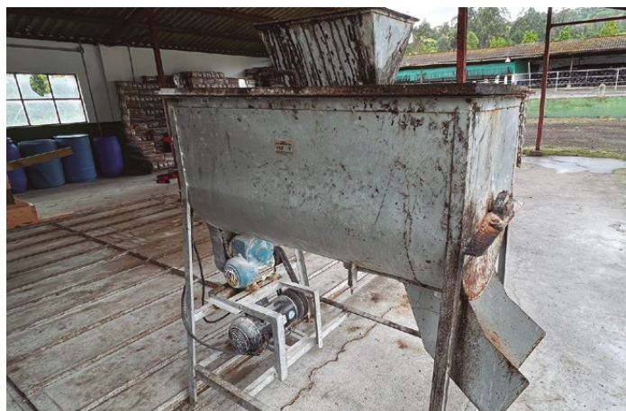
Figura 22. Mezcladora horizontal de 50 kg.
