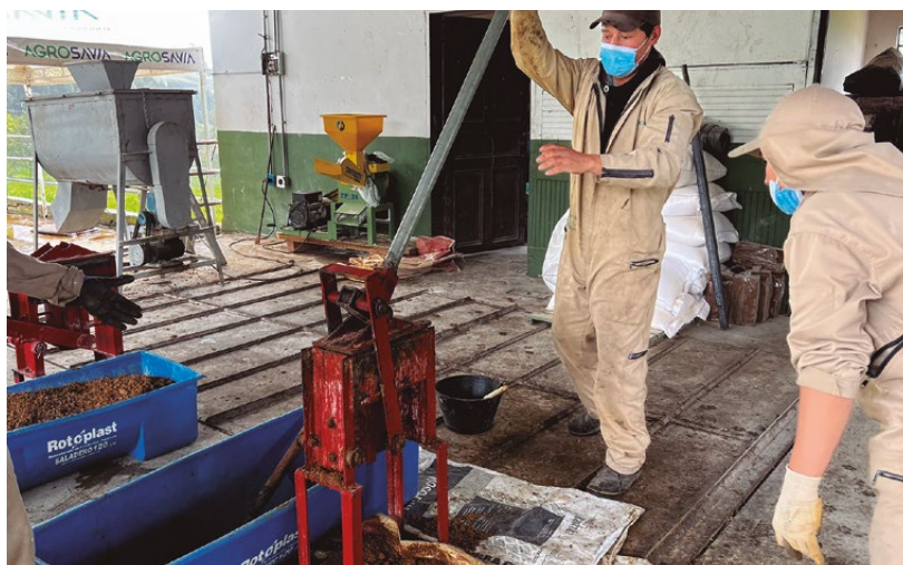
Figura 30. Compactación del BMN con el uso de una prensa tipo CIMVA.
