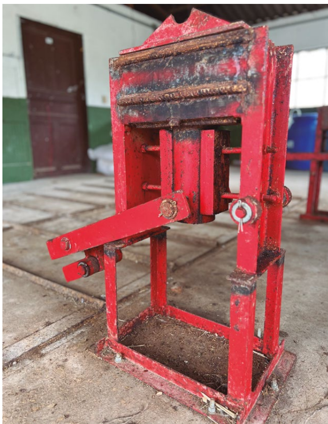
Figura 24. Prensa tipo CIMVA para la elaboración de BMN.
