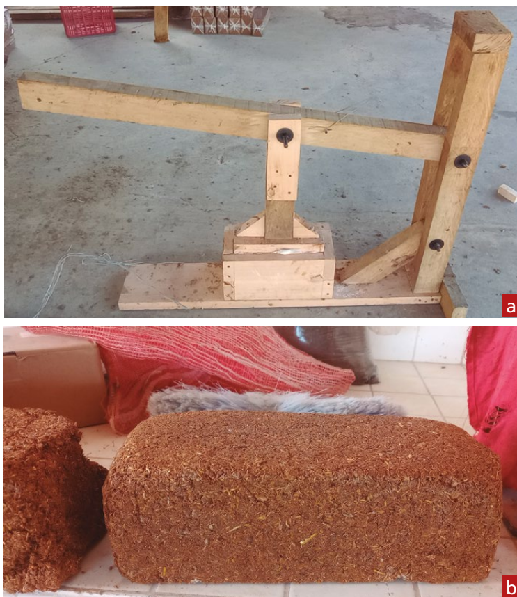
Figura 34. Prensa para la elaboración de BMN. a. Prensa artesanal de madera; b. BMN hechos con la prensa artesanal.
