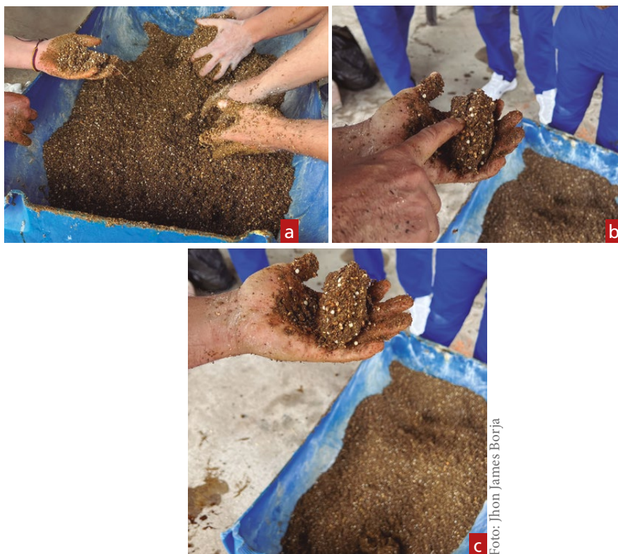
Figura 29. Prueba de puño. a. Mezcla con exceso en melaza; b. Mezcla con exceso de cal; c. Mezcla ideal para prensado.
