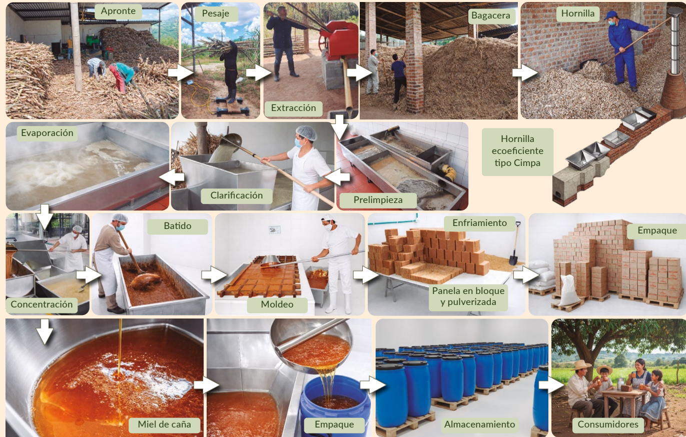
Etapas de transformación de caña de azúcar en miel y panela.
