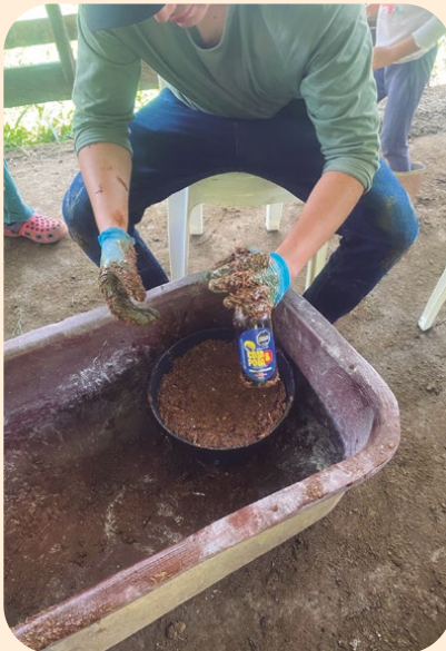
4. Compacte en moldes (baldes de trabajo de 5 kg).
