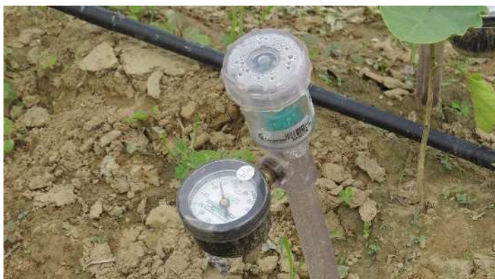
Figura 20. Tensiómetro y forma de instalación en el cultivo.
